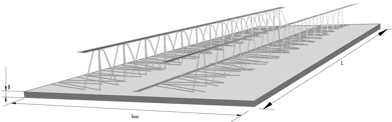
SW Umwelttechnik produce predale din beton armat precomprimat utilizate ca și cofraj pierdut pentru plansee. Predalele se executa cu diferite lungimi, pâna la 9,0 m conform cerințelor. Lățimea predalelor este în mod obisnuit de 1,20 m. La cerere se pot produce și elemente mai înguste. Decupările (străpușerile) se execută în fabrică sau pe sănzier conform desenelor de la proiectant.
